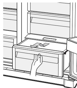
3. Возьмитесь за **большую дверную полку** двумя руками и затем снимите ее, осторожно подняв вверх.
