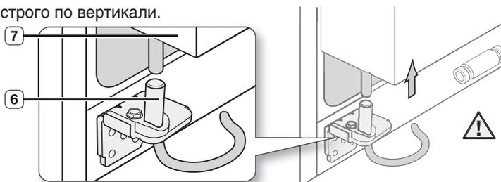
Будьте осторожны, чтобы не пережать дверцей трубку подачи воды и жгуты проводов.
