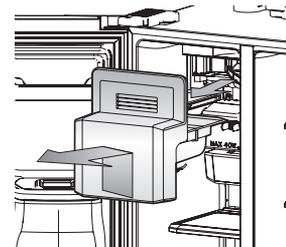
5. Снимите **крышку, закрывающую ножки**, открыв дверцы морозильной и холодильной камер и отвернув три винта. Сняв винты, отделите крышку от корпуса. Чтобы прикрепить крышку, установите ее на место и затяните три винта.
