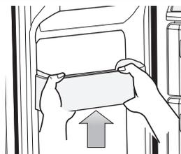
3. Выньте **выдвижной отсек**, потянув его на себя и слегка приподняв вверх.
