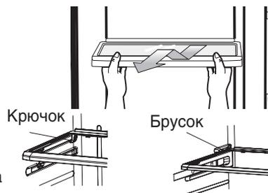
2. Возьмитесь за **дверную полку** двумя руками и затем снимите ее, осторожно подняв вверх.
